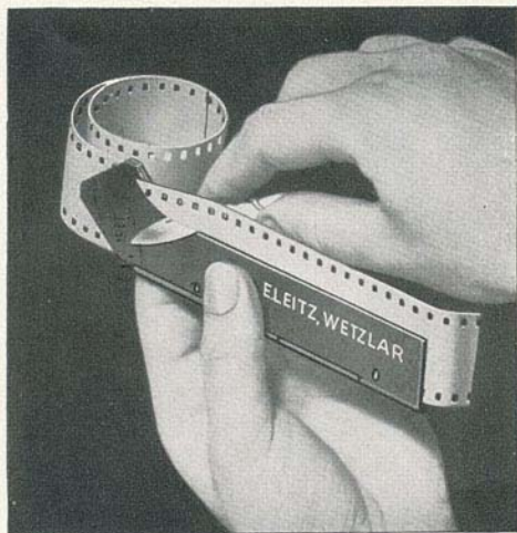
Fig. 24 — Calibro taglia-pellicola. (taglio della pellicola per il rocchetto avvolgitore).
