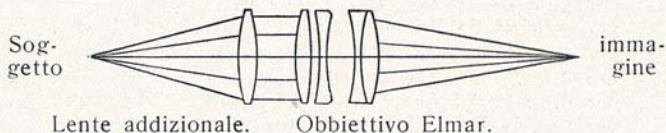
Fig. 43 — Percorso dei raggi nell'obiettivo Elmar con lente addizionale.
