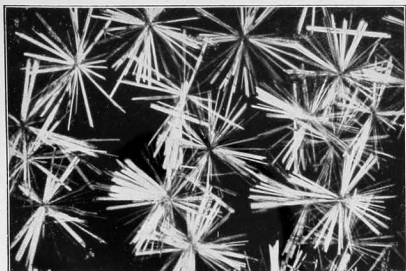
65. Cromato di stronzio. Microfotografia. Illuminazione ultraopaca. Ingrandimento 35 x - Aggiunta micro 1/3.
