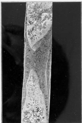
69. Saldatura di rame. Superficie lu- cidata e attaccata. Elmar 50 mm. con anello intermedio. Scala 1:1,5.
