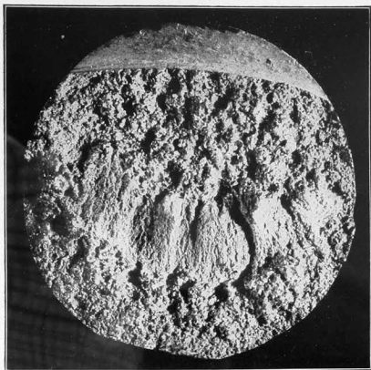
81. Frattura di una lega alluminio-zinco. Elmar 90 mm. su cassetta reflex. Scala 1:3.
