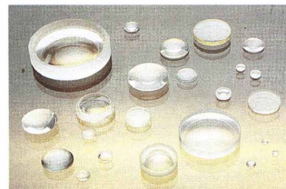
Ed ecco gli elementi ottici finiti, che verranno avviati alla fase di assemblaggio.
