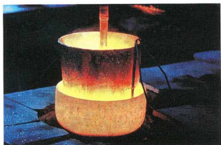
Fusione del vetro in un crogiuolo di platino. La temperatura è di 1700 °C.
