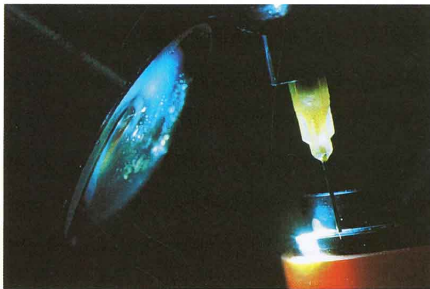
Una siringa controllata via computer deposita il collante che viene poi attivato dai raggi ultravioletti emessi dalla lampada...
