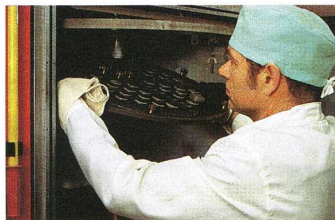
Gli elementi ottici vengono immessi in ambienti sottovuoto per la fase di coating
