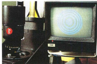
Gli elementi ottici vengono esaminati per mezzo di un interferometro, per verificare il rispetto delle specifiche progettuali.
