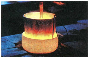
Fusione del vetro in un crogiuolo di platino. La temperatura è di 1700 °C.
