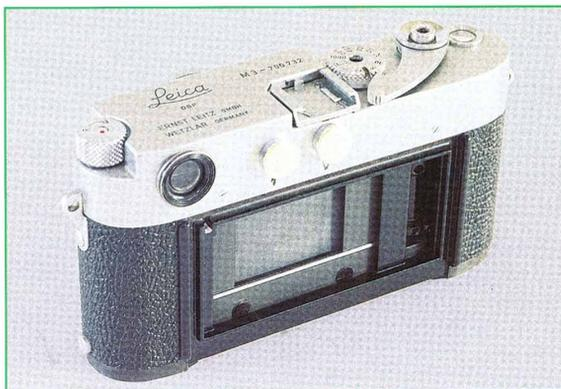
La stessa M3 n° 700 732 fotografata posteriormente e senza dorso apribile per consentire l'esame della zona di scorrimento pellicola, molto diversa da quella delle macchine anche di poco successive. I due inserti metallici tondi, ad esempio, sono scomparsi poco dopo, e le guide cromate di appoggio per la pellicola, in basso, sono diventate due.
