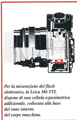
Per la misurazione del flash elettronico, la Leica M6 TTL dispone di una cellula esposimetrica addizionale, collocata alla base del vano interno del corpo macchina.
