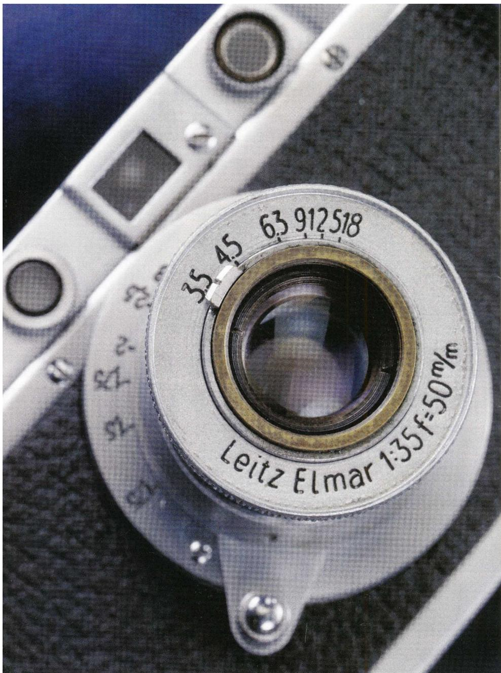
*Attenzione: questo è un falso. Si tratta di una combinazione Leica in montatura a vite 39x1, con tanto di logotipi e incisioni imitate, di origine sovietica, direttamente derivata dalle produzioni "ufficiali" Zorki e Fed. Da non confondere con l'originale.*
