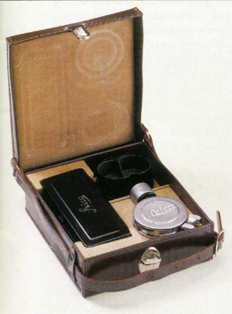
Stemar 3,5/33mm (OISBO). Dispositivo stereo prodotto dalla filiale Ernst Leitz Canada Ltd dal 1954 al 1957. Due obiettivi accostati scompongono il formato completo 24x36mm in due fotogrammi stereoscopici 18x24mm a inquadratura verticale.
