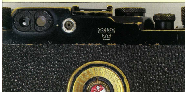
Leica IIIg militare per la Svezia (1960). Lotto di centoventicinque apparecchi appositamente predisposti per l'uso a bassissime temperature. Analogo a un precedente lotto di cento Leica IIIf, altrettanto modificate nel 1956, questo è identificato dall'incisione di tre corone sul retro.
