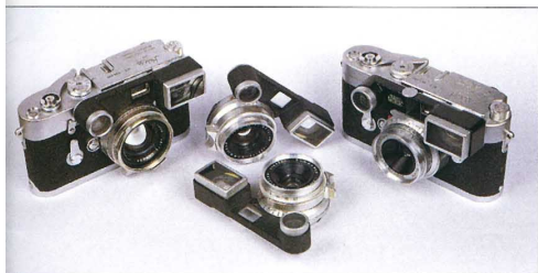
Grandangolari 35mm dei tardi anni Cinquanta con gli occhiali: Summilux f/1,4 e Summicron f/2 su corpi macchina Leica M3 e due Summaron f/2,8.
