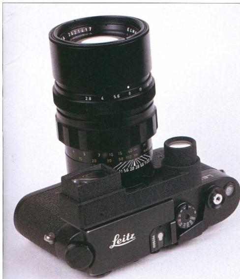
Teleobiettivo Elmarit 2,8/135mm (prima versione) su Leica M4-2. Il mirino ingranditore supplementare, rapporto 1,4x, è finalizzato alla precisione della misurazione telemetrica.
