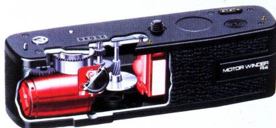
Lo spaccato del winder e del motor-drive mostra la differenza nella posizione del motore (il cilindro rosso) nonché il sistema di trasmissione del moto che, nel winder, ha un elemento a frizione (si veda anche a pag. 25).
