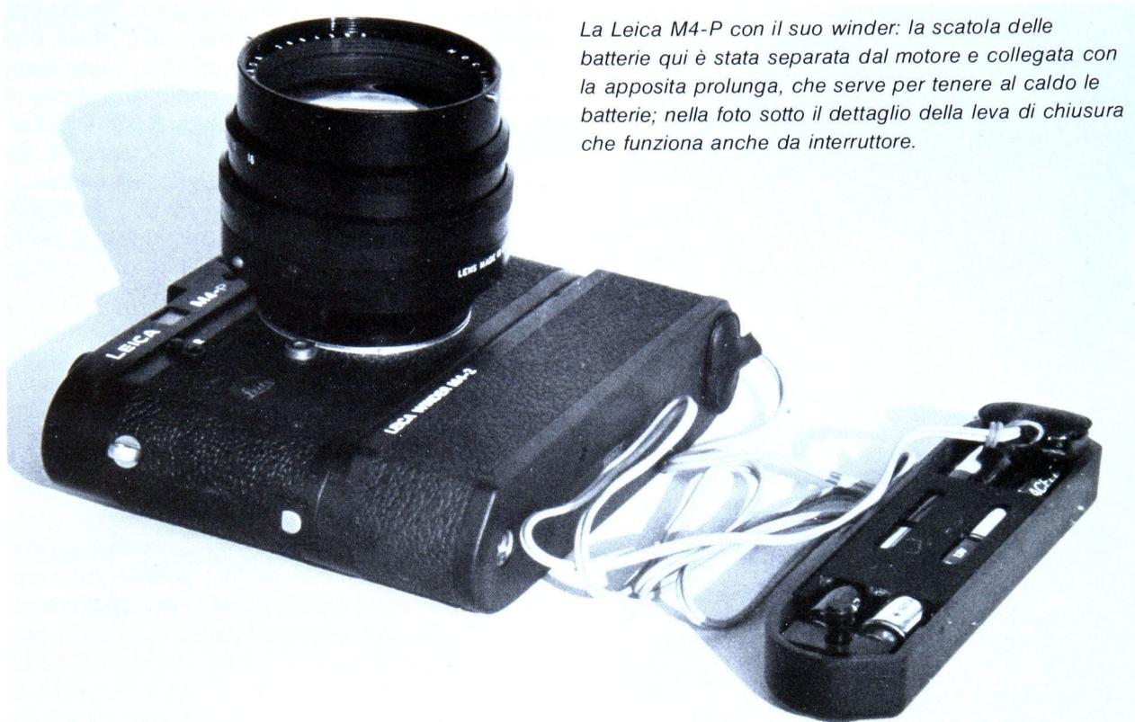
*La Leica M4-P con il suo winder: la scatola delle batterie qui è stata separata dal motore e collegata con la apposita prolunga, che serve per tenere al caldo le batterie; nella foto sotto il dettaglio della leva di chiusura che funziona anche da interruttore.*
