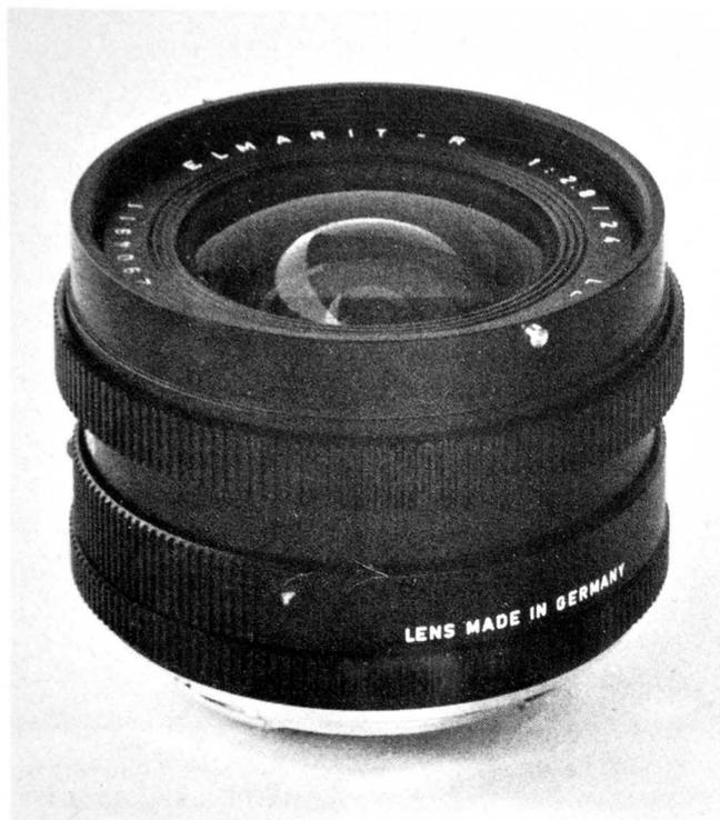
Il supergrandangolare da 24 mm per le macchine di tipo reflex è stato annunciato alla Photokina del 1974: presentava una innovazione nel fatto di avere il cosiddetto «floating element» cioè una parte delle lenti si sposta, col movimento di messa a fuoco, relativamente al resto dell'obiettivo; nel caso particolare dell'Elmarit-R da 24 mm è tutto il gruppo delle 5 lenti anteriori che si sposta rispetto alle 4 posteriori.
